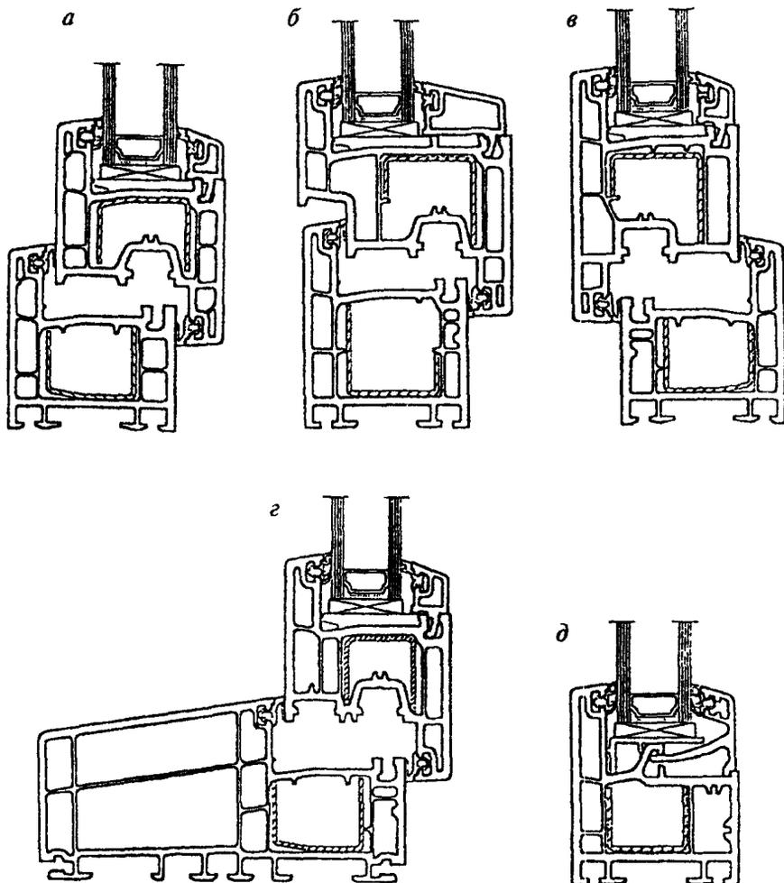
*a* — оконная система из трехкамерных профилей; *б* — оконная система с четырехкамерной створкой и трехкамерной коробкой (расположение наружных стенок створок и коробок в одной плоскости); *в* — оконная система из трехкамерных профилей (открывание наружу); *г* — оконная система из многокамерных профилей с расширенной коробкой; *д* — оконная система с остекленной коробкой
