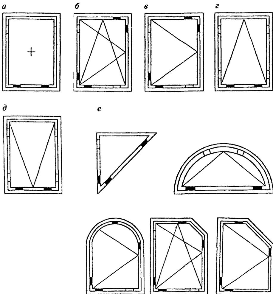
Виды открывания оконных блоков *a* — неоткрывающиеся, *б* — поворотнo-откиднoе, *в* — поворотнoе (распашнoе), *г* — откиднoе, *д* — подвеснoе, *е* — установка подкладок в фигурных оконных блоках
