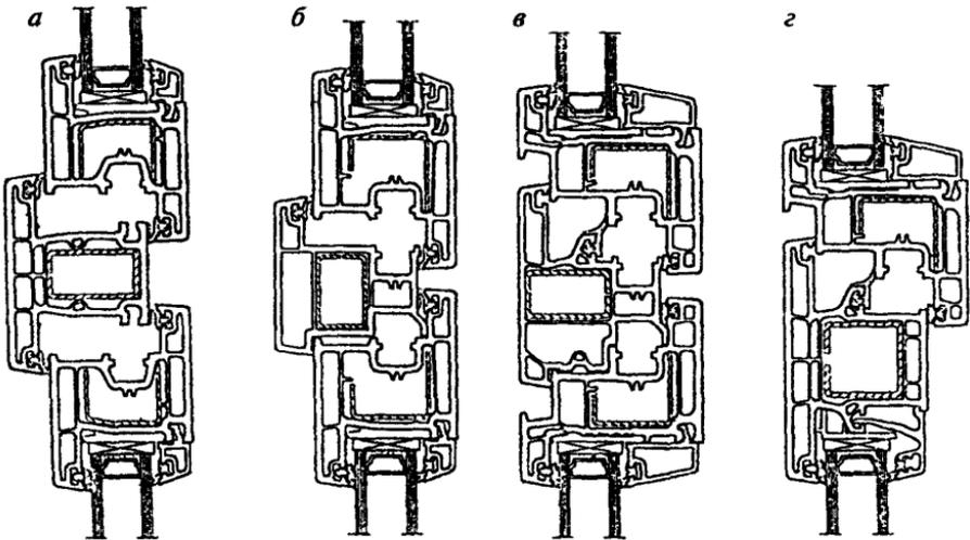
*a* — импостной притвор оконной системы с наружным и внутренним уплотнениями; *б* — штульповой (безимпостный) притвор оконной системы с наружным и внутренним уплотнениями; *в* — штульповой (безимпостный) притвор оконной системы со средним и внутренним уплотнениями; *г* — импостный притвор неоткрывающихся и открывающихся элементов оконной системы со средним и внутренним уплотнениями
