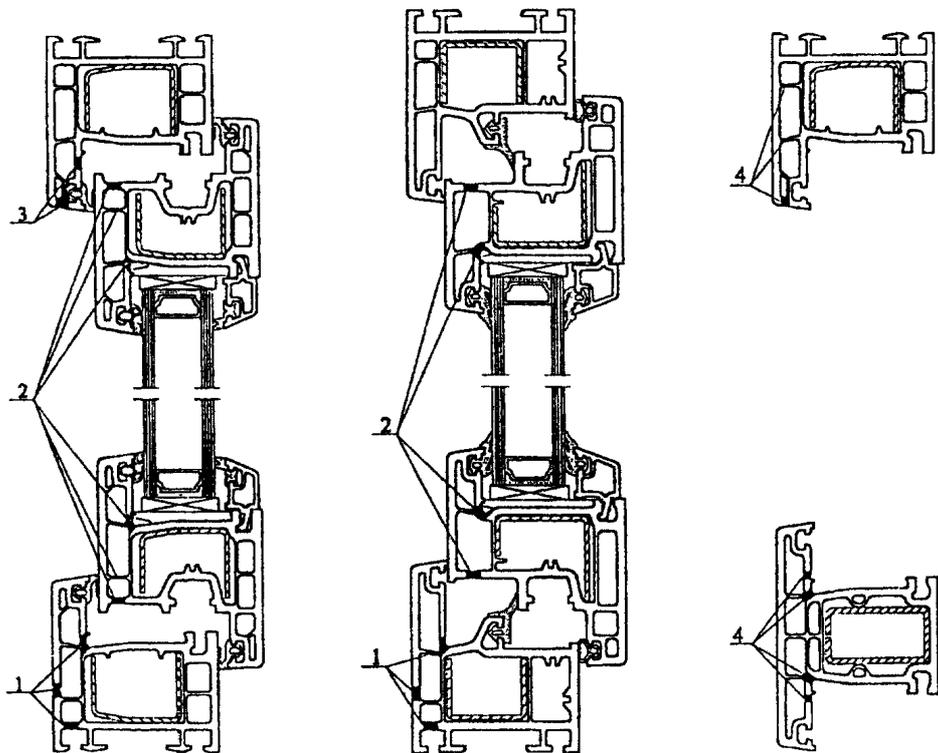
1 — водосливные отверстия; 2 — отверстия для осушения полости между кромками стеклопакета и фальцами профилей; 3 — отверстия для компенсации ветрового давления; 4 — отверстия для вентиляции наружных камер цветных профилей
