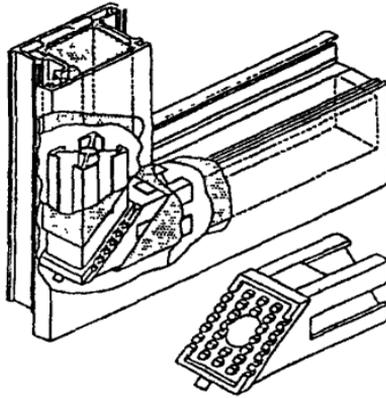
**Рисунок 7** — Вкладыш для усиления угловых соединений
