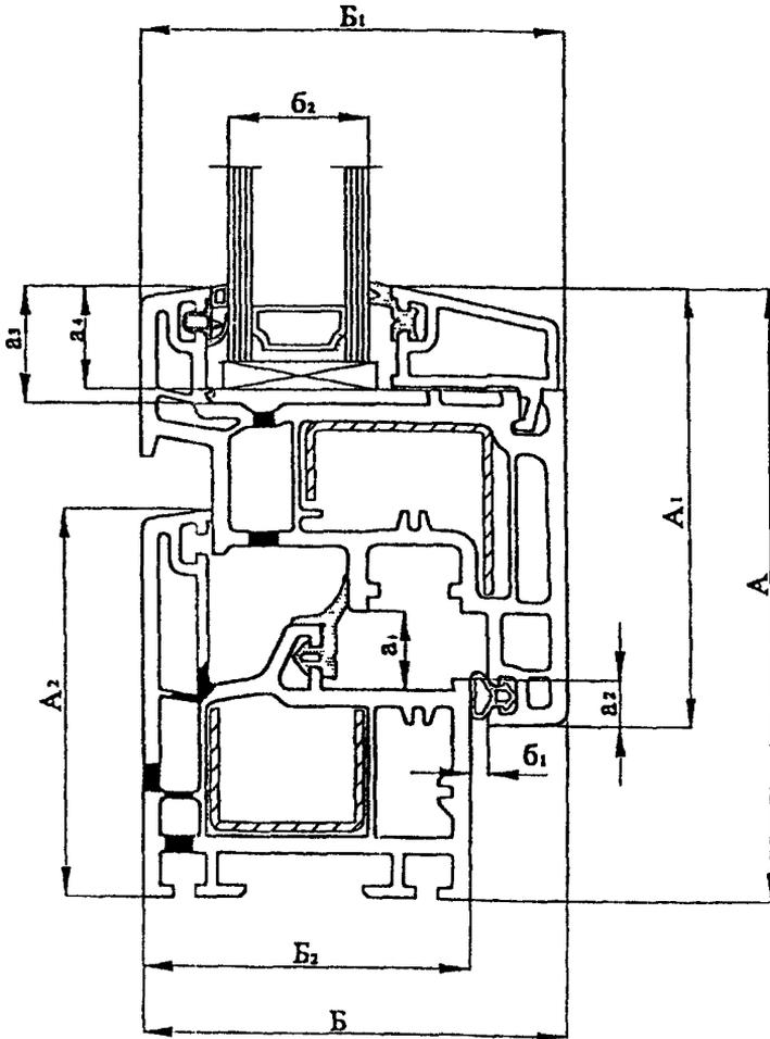
$A$  — высота комбинации профилей;  $A_1$  — высота профиля створки;  $A_2$  — высота профиля коробки;  $B$  — ширина комбинации профиля;  $B_1$  — ширина профиля створки,  $B_2$  — ширина профиля коробки;  $a_1$  — размер фальцшлюфта (зазор в притворе);  $a_2$  — размер притвора под наплавом;  $a_3$  — высота фальца (четверти) остекления,  $a_4$  — высота защемления стеклопакета;  $b_1$  — размер зазора под наплавом;  $b_2$  — толщина стеклопакета
