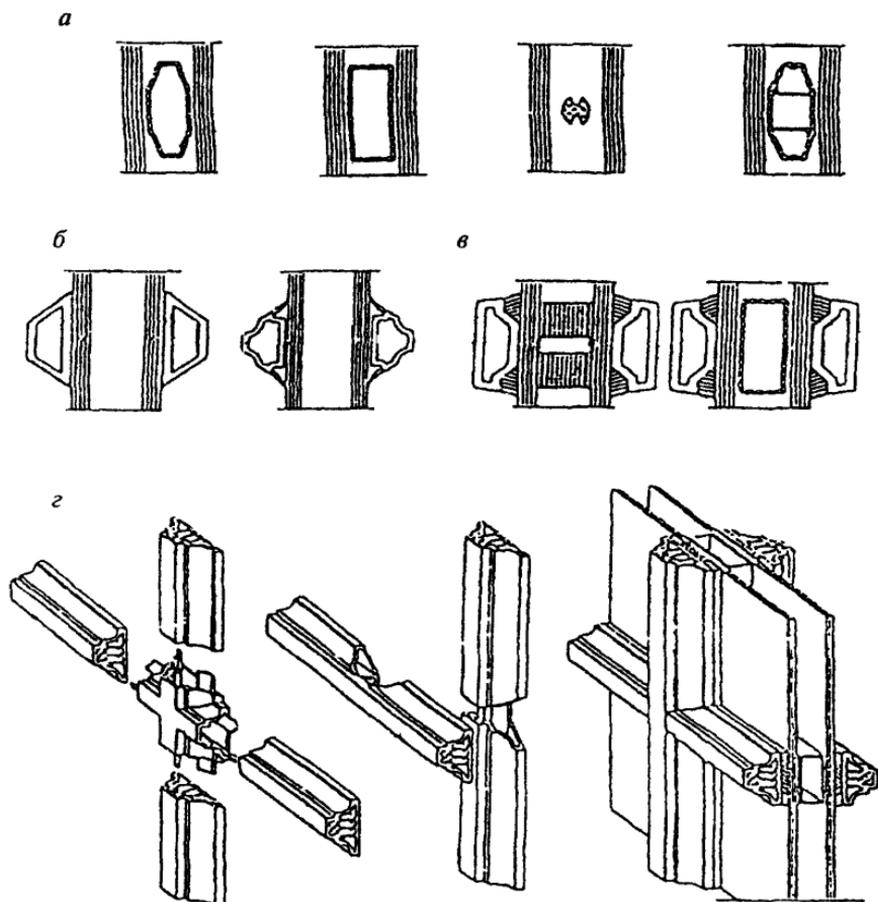
*a* — профили внутренней рамки стеклопакета; *б* — накладные декоративные раскладки; *в* — вариант комбинированного применения накладных раскладок и внутренней рамки стеклопакета; *г* — переплетные соединения раскладок
